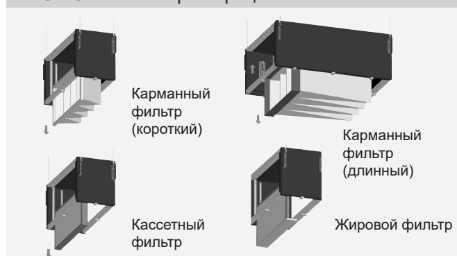
Рис. 15 – замена фильтрационных элементов
