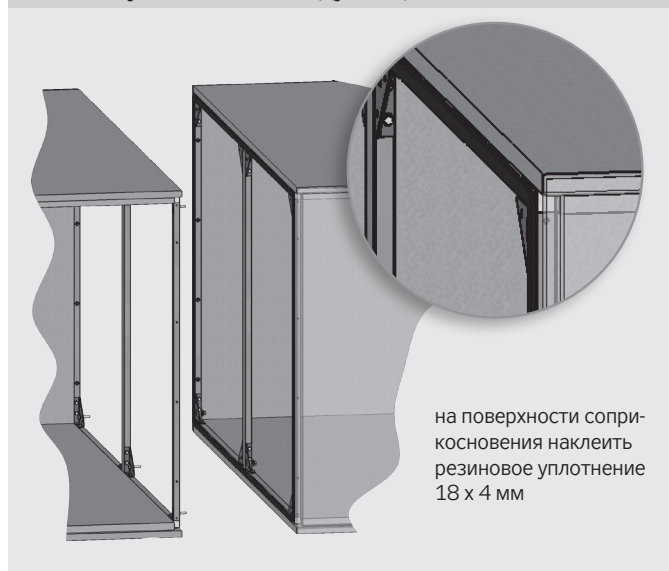
Рис. 7 – уплотнение между секциями
