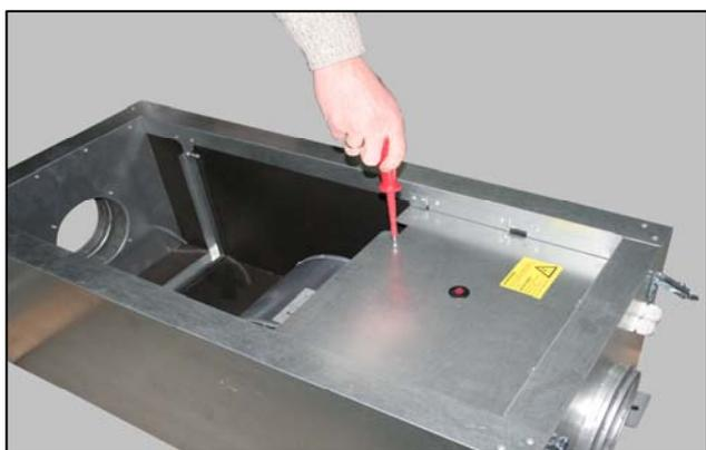
7. Зафиксируйте защитную панель отсека нагревателя с помощью саморезов.
