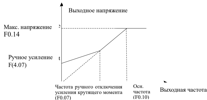
Рис.6-10 Схема усиления крутящего момента
