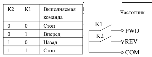
Рис.6-13 Двухпроводной режим управления 1
