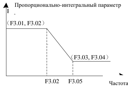
Рис. 6-7 Схема пропорционально-интегральных параметров контура скорости
